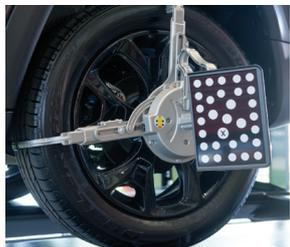
Utilizando una fuerza óptima, la abrazadera se fija al neumático sin hacer contacto con la llanta, lo que proporciona una operación de sujeción segura, rápida y uniforme.
