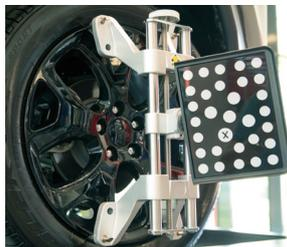
Con un diseño autocentrante, las garras de dos lados garantizan un agarre sólido y rápido, incluso sobre tapacubos.
